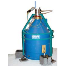
1995 Superleitendes Gravimeter (GWR Co5) in Wien installiert – Zusammenarbeit ZAMG / IMGW. Seit 2007 am Conrad Observatorium.
